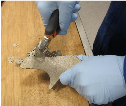
Bild 3: Händisches trennen filigraner Stützstrukturen
